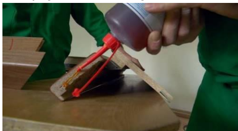
nanesení lepidla na styčné plochy dílů
