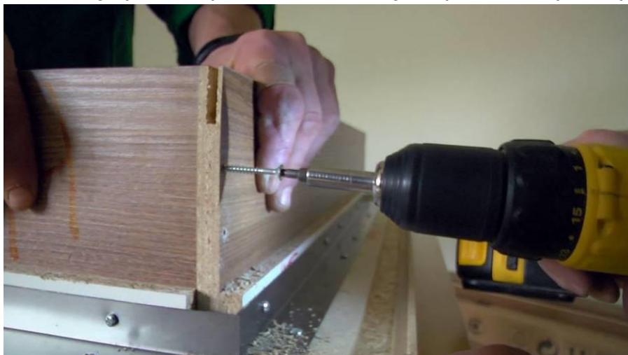
spojení dílů ostění vrutem
