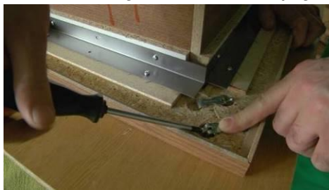
ukotvení spojů pomocí excentrů
